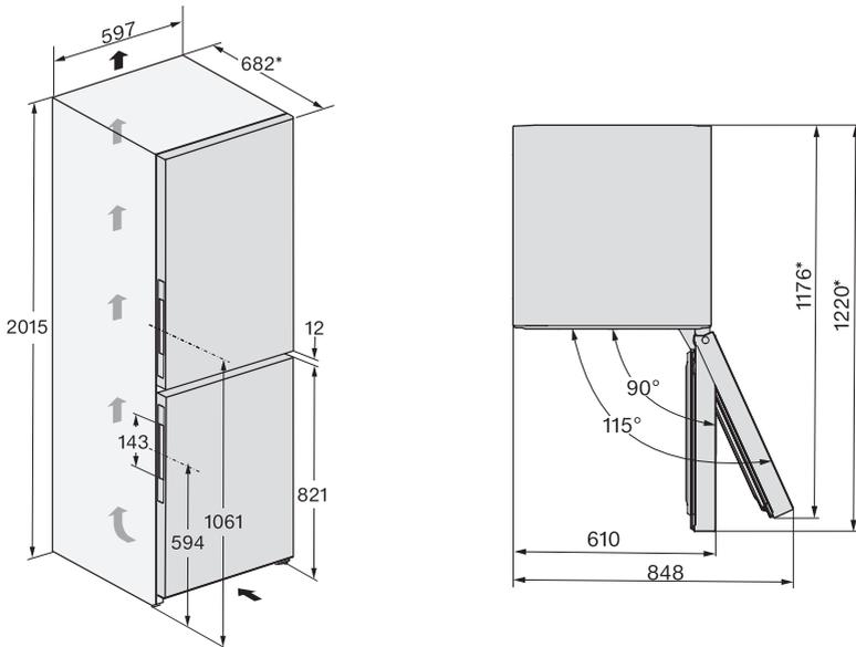
\* Medida sin distanciador de pared montado. En caso de utilizar los distanciadores de pared suministrados, la profundidad del aparato aumenta aprox. 15 mm.
