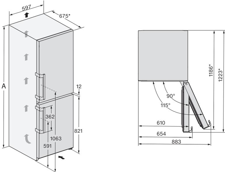
\* Medida sin distanciador de pared montado. En caso de utilizar los distanciadores de pared suministrados, la profundidad del aparato aumenta aprox. 15 mm.
