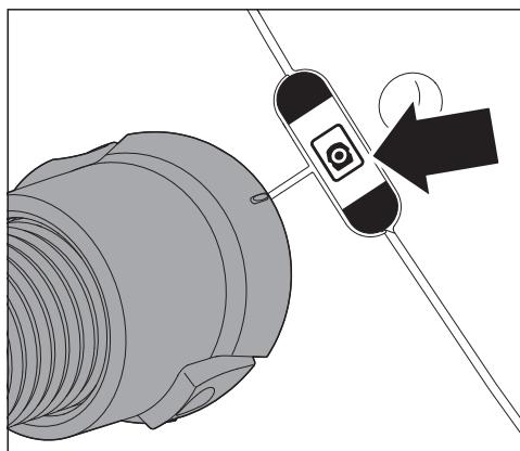
Zamenite kesu za usisivač kada se skala na kontrolnom prozorčiku indikatora potrebe zamene kese za usisivač ispuni crvenom bojom.
