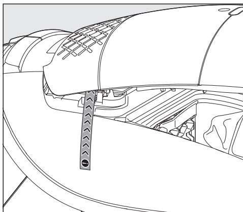
Ukoliko na vašem usisivaču bočno iz prostora za prašinu viri informativna traka, morate da aktivirate indikator potrebe zamene filtera izlaznog vazduha timestrip®.
