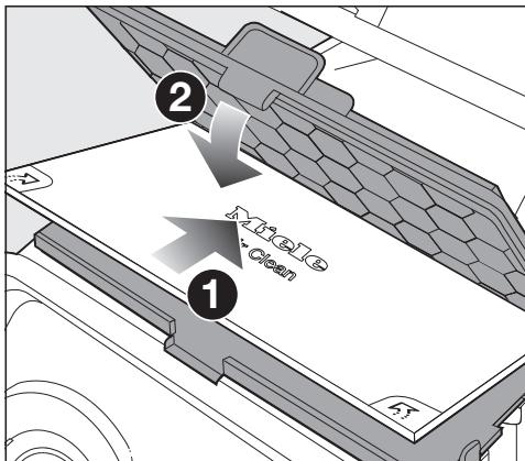
2. Ukoliko umesto filtera izlaznog vazduha **b**, **c**, **d** ili **e** postavite filter izlaznog vazduha **a**, onda morate obavezno da ga postavite u rešetku filtera\*.
