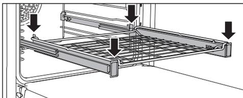
La portata max. delle guide FlexiClip è di 15 kg.
