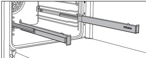
È possibile montare le guide completamente estraibili FlexiClip su ogni ripiano.
