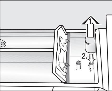
1. Sfilare il dispositivo di aspirazione dalla vaschetta
