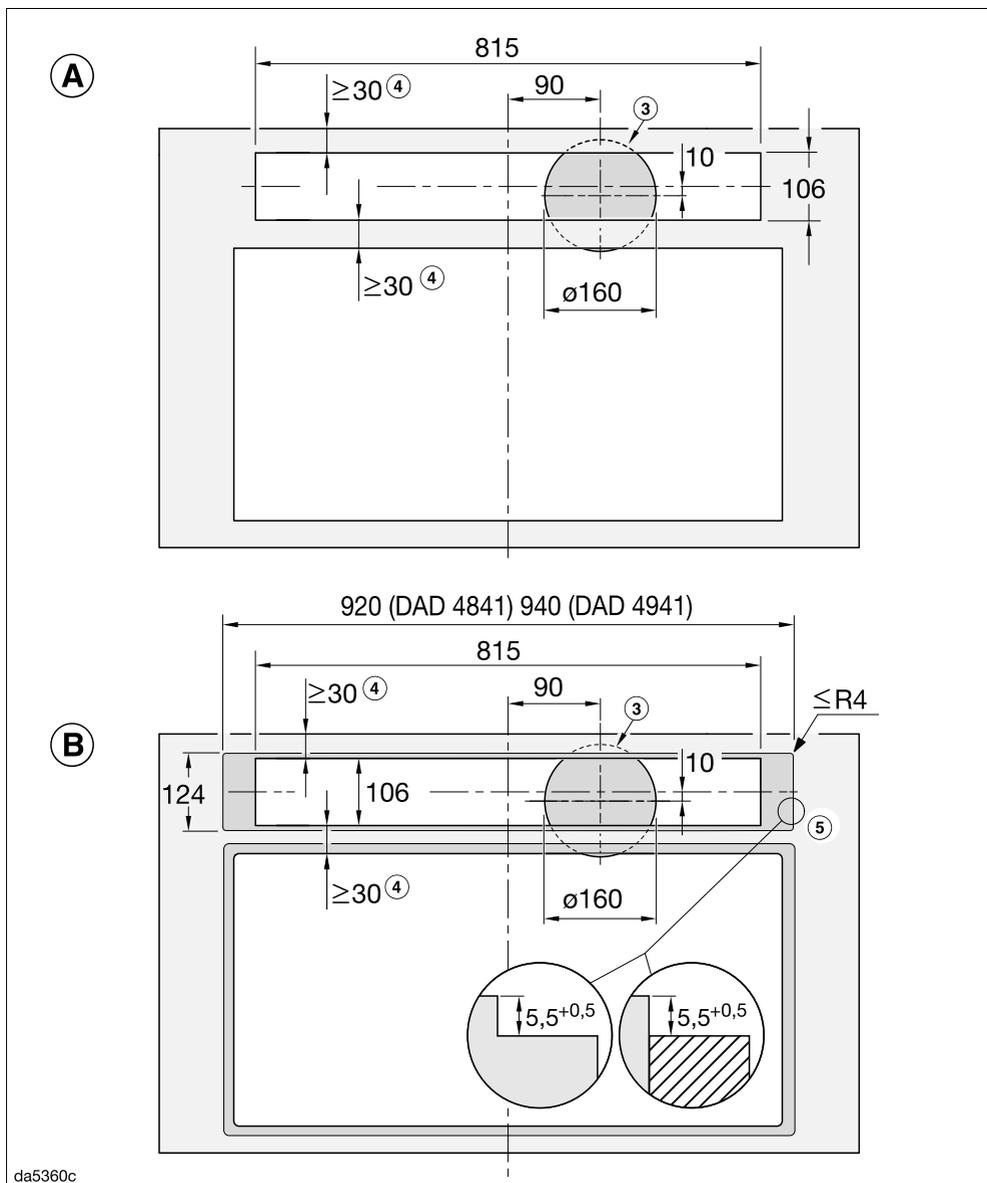
**A** Installazione mediante appoggio
