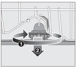
Ruotare il raccordo del braccio irroratore centrale in senso orario (vista dall'alto) e toglierlo (2).
