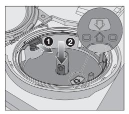
■ Tirare la linguetta gialla di apertura nella direzione della freccia ① e inserire contemporaneamente il supporto del PowerDisk ②. Le frecce nel supporto del PowerDisk e nella finestrella devono essere rivolte l'una contro l'altra. Il supporto deve appoggiare in modo piano.
