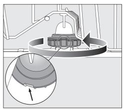
Reinserire il braccio irroratore centrale e ruotare il raccordo in senso antiorario (vista dall'alto) finché si aggancia. Accertarsi le fessure nel blocco siano sovrapposte.
