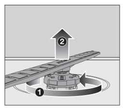
■ Ruotare il raccordo del braccio irroratore inferiore in senso antiorario ① (vista dal basso) e togliere il braccio verso l'alto ②.
