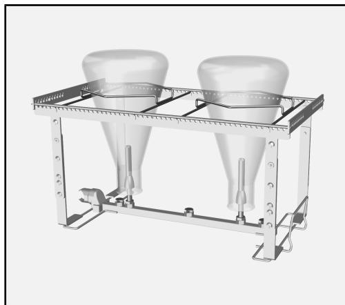
Erlenmeyerkolvarna ligger på en hållare i modulens hållarram. Kulan på injektordysans undre ände ska ligga inuti diskgodsets hals. Detta skyddar kanten från att spricka.
