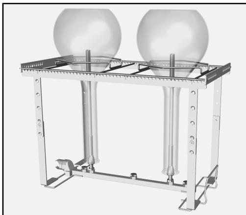
I matracci poggiano sul supporto collocato sul telaio del modulo. Il cono sull'estremità dell'ugello iniettore si deve trovare dentro il collo degli oggetti. Questo impedisce che il bordo possa staccarsi.
