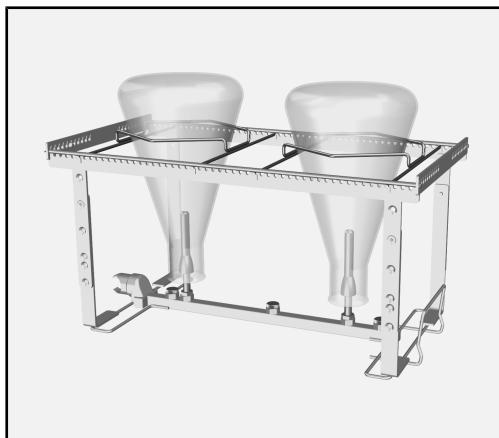
Erlenmeyerkolbene hviler på holderen i modulens holderamme. Kjeglen nederste på enden av injektordysen bør være inne i halsen på glasset. Det beskytter kanten fra å sprekke.
