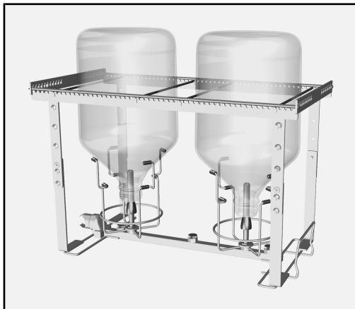
Laboratorieflaskene hviler på 4 punkter i holderen, flaskehalsen bør ikke berøre vanntilførselen.
