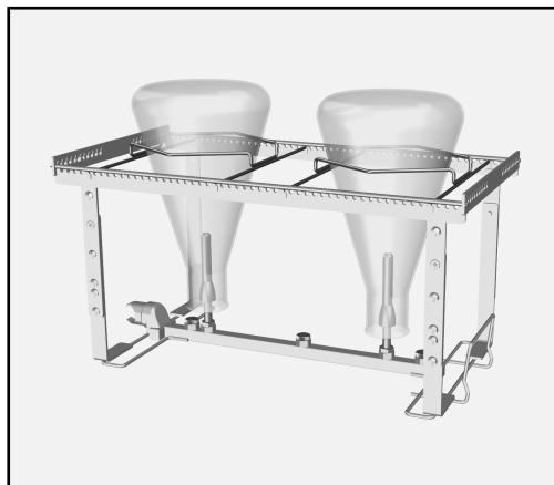
De erlenmeyers liggen op de steun in het frame van de module. De kegel op het onderste uiteinde van de injector moet zich in de hals van het spoelgoed bevinden. Dit voorkomt dat er stukjes van de rand afbreken.
