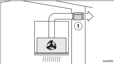
Bei Abluftbetrieb dämpft der Schalldämpfer sowohl Gebläsegeräusche nach außen als auch Außengeräusche, die über die Abluftleitung in die Küche dringen (z. B. Straßenlärm). Dazu wird der Schalldämpfer möglichst nah vor dem Abluftaustritt ① positioniert.
