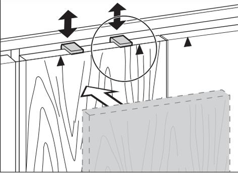
**Suggerimento:** Inserire i sostegni di montaggio ② con il frontale del mobile all'altezza dell'anta dei mobili adiacenti.
