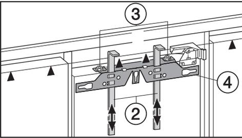
■ Svitare i dadi ③ e togliere la traversa di fissaggio ④ insieme ai sostegni di montaggio ②.
