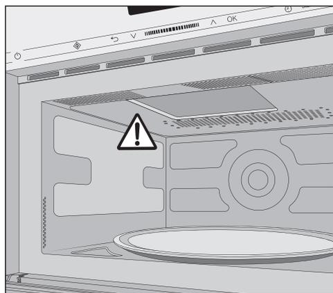
N'enlevez pas le cache de protection de l'orifice de sortie des micro-ondes dans l'enceinte.
