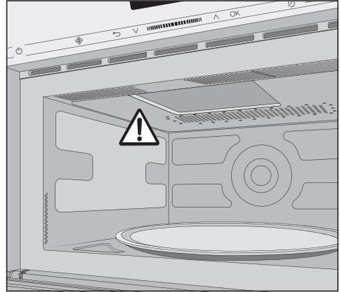
Ne retirez surtout pas le cache qui recouvre l'orifice de sortie des micro-ondes dans l'enceinte du four.
