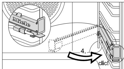
■ Опустіть напрямну FlexiClip назад і вставте її зверху до фіксації до характерного звуку (4.).
