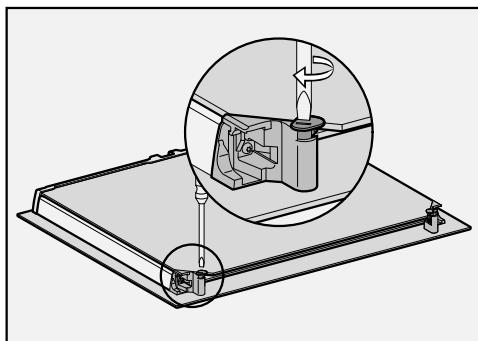
■ За допомогою шліцевої викрутки поверніть назовні два замки дверних панелей.
