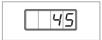
Ao fim de aprox. 2 segundos a indicação altera e aparece um circulo a girar ou o tempo adquirido (funcionamento por tempo) por ex. 45 minutos no caso de passar a ferro.
