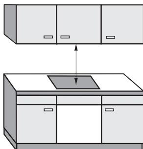
Između ProLine elementa i iznad postavljene nape mora ostati razmak kojeg preporučuje proizvođač nape. Ukoliko proizvođač nape nije naveo takve podatke ili ako su iznad ProLine elementa postavljeni lako zapaljivi materijali (npr. ploča za vješanje), sigurnosni razmak mora iznositi barem 500 mm.
