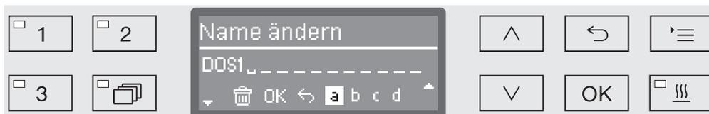
In der mittleren Zeile wird der aktuelle Name ausgegeben. Dieser kann mit den Optionen aus der unteren Zeile bearbeitet werden. Die oberste Zeile nennt die jeweils ausgewählte Option aus der unteren Zeile.
