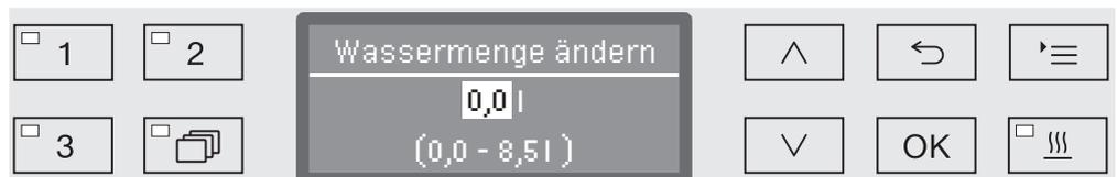
Die Wassermenge kann in 0,5 l Schritten erhöht oder wieder auf die Werkseinstellung zurückgesetzt werden. In der untersten Zeile ist der mögliche Einstellungsbereich angegeben. Der Einstellung „0 l“ entspricht der Werkseinstellung.
