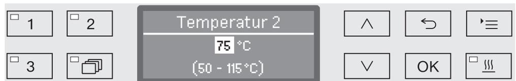
Die Temperatur wird in 5 °-Schritten eingestellt. In der untersten Zeile ist der mögliche Einstellungsbereich angegeben.
