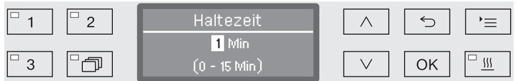
Die Einstellung erfolgt in 1 Min (Minuten) Schritten. In der untersten Zeile ist der mögliche Einstellungsbereich angegeben.
