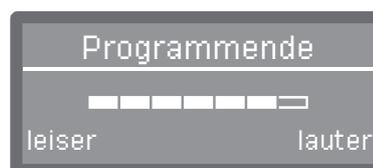
Der Lautstärkegrad wird durch eine Balkenanzeige dargestellt. In der niedrigsten Einstellung ist das Summersignal ausgeschaltet.
