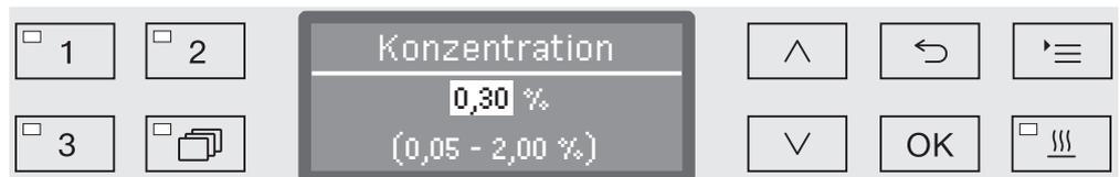
Die Dosierkonzentration kann in 0,01er-Schritten eingestellt werden. In der untersten Zeile ist der mögliche Einstellungsbereich angegeben.
