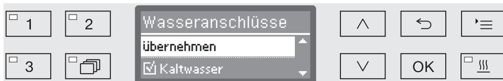
Die Einstellung der Wasseranschlüsse erfolgt über Mehrfachauswahl. In der Displayanzeige ist allen Wasseranschlüssen ein Kästchen  vorangestellt. Ist der Wasseranschluss aktiviert, ist darin ein Haken zu sehen . Durch Auswahl der Wasseranschlüsse können diese aktiviert bzw. deaktiviert werden.
