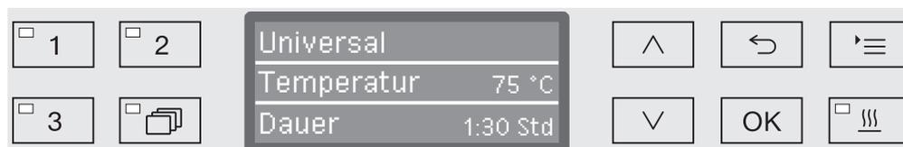
Die LED im angewählten Tastenfeld leuchtet auf und im Display wird das entsprechende Programm angezeigt. Zudem fängt die LED im Tastenfeld *Start/Stop* an zu blinken.
