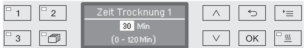
Die Haltezeit wird in 1 Minuten Schritten eingestellt. In der untersten Zeile ist der mögliche Einstellungsbereich angegeben.
