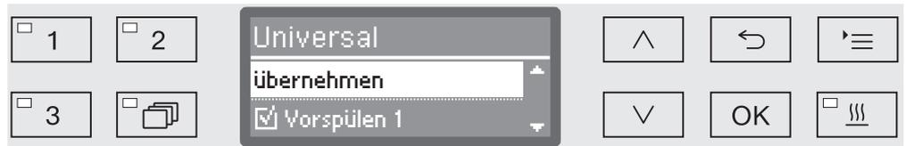
Die Zuordnung erfolgt über Mehrfachauswahl. In der Displayanzeige ist allen Spülblöcken ein Kästchen  vorangestellt. Ist der Spülblock dem Programm zugeordnet, ist darin ein Haken zu sehen . Durch Auswahl der Spülblöcke können diese dem Programm zugeordnet oder die Zuordnung wieder entfernt werden.
