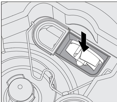
Unter dem Rückschlagventil befindet sich das Flügelrad der Ablaufpumpe (Pfeil).
