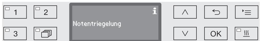
Die Meldung bleibt bis zum Schließen der Tür im Display eingeblendet. Im ausgeschalteten Zustand erfolgt keine Protokollierung.
