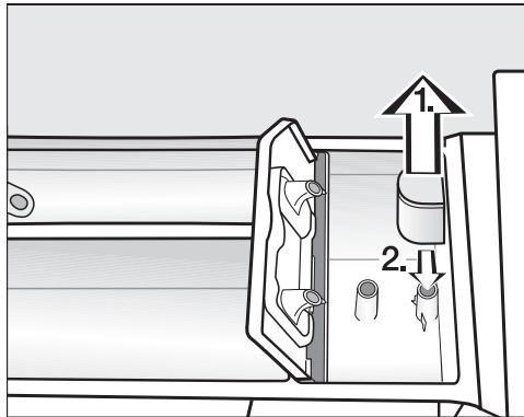
1. Usisnu cjevčicu izvucite iz pretinca ☘ te isperite pod mlazom čiste, tople vode. Također očistite cijev preko koje se umeće usisna cjevčica.
