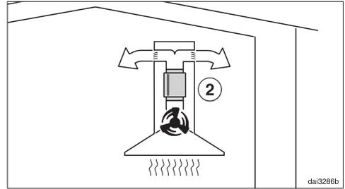
En mode recyclage, le réducteur de bruit se trouve entre le raccord d'évacuation et le dérivateur ②. Vérifiez l'espace d'encastrement.
