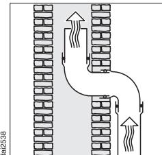
Ako se odvod zraka provodi kroz dimnjak, odvodni nastavak se mora usmjeriti u smjeru strujanja zraka.
