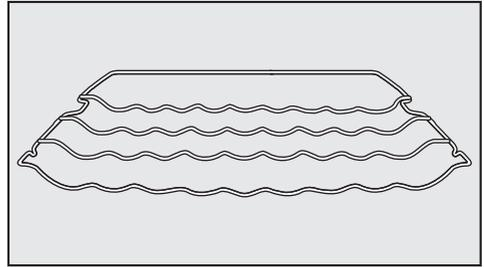
Die Flaschenablage können Sie variabel in das Kältegerät einsetzen.
