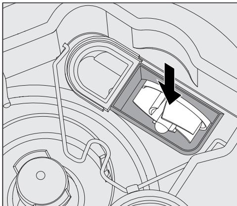
Sotto la valvola antiritorno si trova il girante della pompa di scarico (freccia).
