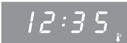
Le témoin de température
