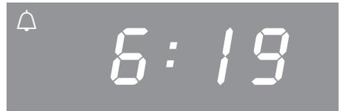
La durée de minuterie est enregistrée et s'écoule seconde par seconde. Le symbole
