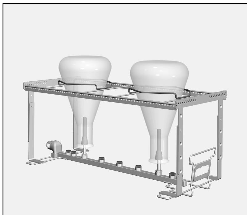
Erlenmeyerkolvarna ligger på en hållare i modulens hållarram.
