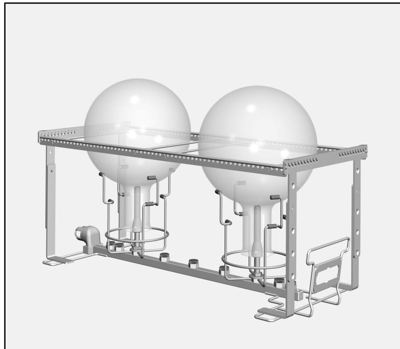
Rundkolbene hviler på 4 punkter i holderen, halsen bør ikke berøre vanntilførselen.
