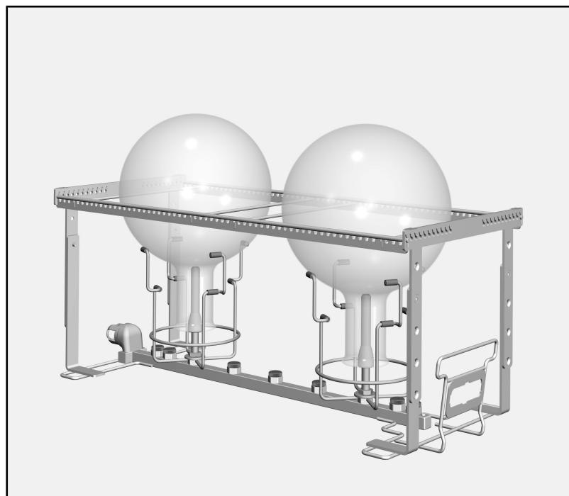
Les ballons gradués reposent sur 4 points de support, leur col ne doit pas toucher l'arrivée d'eau.
