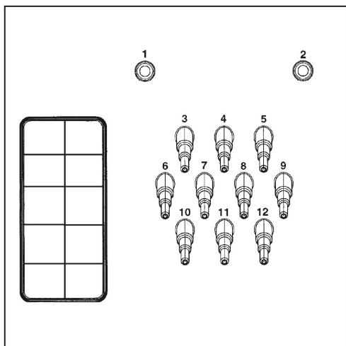
Conexiones de bomba dosificadora en la parte posterior del aparato
