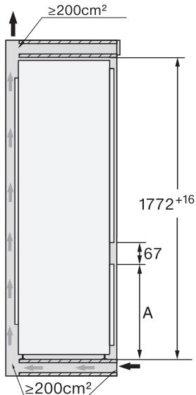
\* Η κατανάλωση ρεύματος που αναφέρεται υπολογίστηκε με βάθος εσοχής 560 mm. Η συσκευή μπορεί να λειτουργήσει σε βάθος εσοχής 550 mm, έχει όμως ελάχιστα αυξημένη κατανάλωση ρεύματος.
