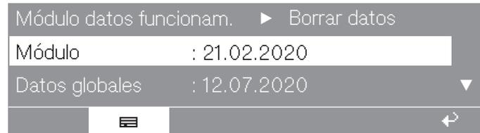
Con el punto de menú Módulo se borran los Total de datos y los Datos del programa de los Datos de funcionamiento.
