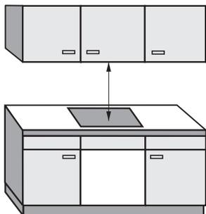
La distance de sécurité entre la table de cuisson et la hotte prescrite par le fabricant de la hotte doit être respectée.
