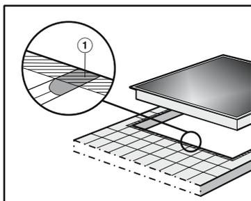
► Les joints ① et la zone hachurée sous la table de cuisson doivent former une surface lisse et plane afin que la table de cuisson s'encastre bien sur son support et que le joint d'étanchéité situé sous tout le pourtour de la table de cuisson assure une étanchéité suffisante avec le plan de travail.
