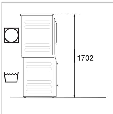
Un cadre de superposition\* est nécessaire. Le montage doit être effectué par un technicien agréé par Miele.
