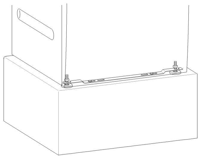
Mit dem beiliegenden Befestigungsbügel wird das Gerät über die beiden vorderen Standfüsse am Boden befestigt. Das Befestigungsmaterial ist für eine Dübel-Befestigung auf Betonboden ausgelegt.
