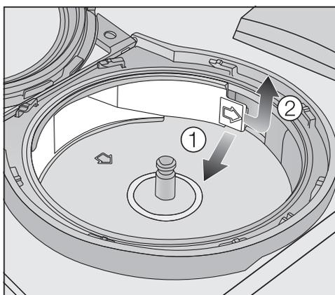
■ Déverrouillez le canal d'écoulement au niveau de la languette (flèche) ① et l'extraire ②.
