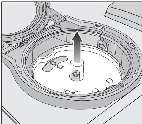
■ Retirez le logement du PowerDisk par le haut en le saisissant par les surfaces jaunes. Ce faisant, ne pas le tirer au niveau de la languette latérale.
