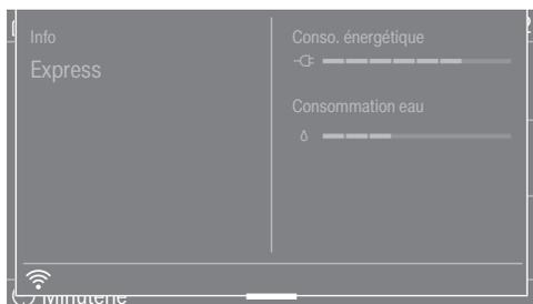
Le menu déroulant affiche la consommation d'énergie et d'eau ainsi que, le cas échéant, les options sélectionnées et l'état de connexion du lave-vaisselle (📶 connecté, 🚫 non connecté).
