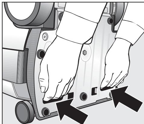
■ Pour le transport, utilisez les 2 poignées situées sur la face inférieure de l'appareil.
