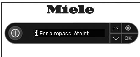
Si le fer à repasser reste immobile pendant plus de 3 minutes, le chauffage du fer à repasser s'arrête automatiquement. La coupure du chauffage est indiquée sur l'écran par le message
