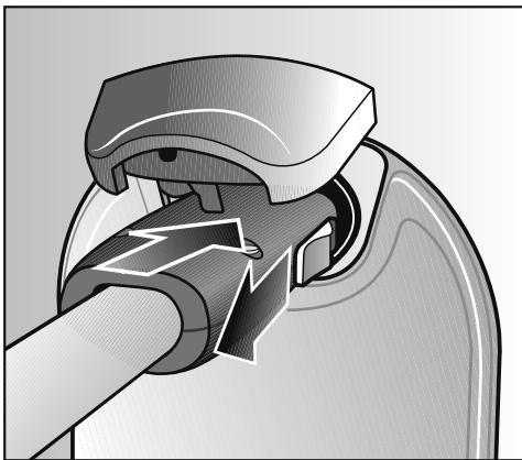
Vous pouvez raccorder alternativement le fer à repasser et le Steamer au raccordement de vapeur à tout moment.
