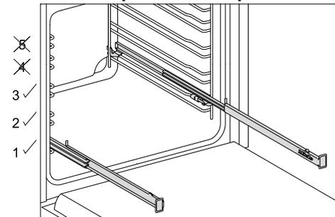
Solo se pueden montar las guías telescópicas FlexiClip en los niveles 1, 2 y 3.
