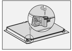
■ Tournez les deux dispositifs de blocage des vitres vers l'intérieur à l'aide d'un tournevis plat.
