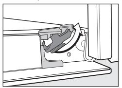
Déverrouillez les étriers de blocage en les tournant jusqu'à la butée. Un démontage incorrect de la porte peut endommager le four vapeur combiné.
