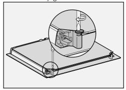
Tournez les deux dispositifs de blocage des vitres vers l'extérieur à l'aide d'un tournevis plat.
