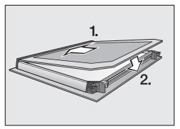
■ Glissez la vitre intérieure, côté sérigraphié mat vers le bas dans la baguette en plastique et déposez-la entre les dispositifs de blocage.
