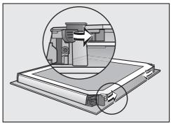
■ Fermez les dispositifs de blocage des vitres en effectuant une rotation vers l'intérieur.
