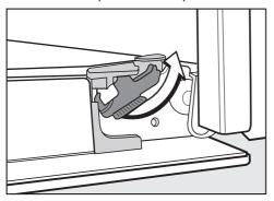
Déverrouillez les étriers de blocage des deux charnières en les tournant jusqu'à la butée. Si vous démontez la porte de façon incorrecte, cela peut endommager le four.
