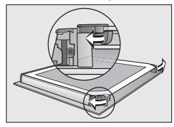
Ouvrez les dispositifs de blocage des vitres en les tournant vers l'extérieur.
