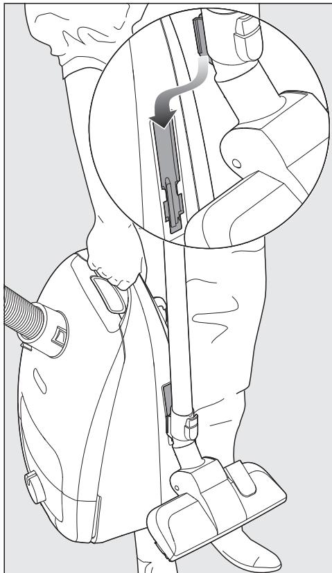
Ukoliko je Vaš usisivač opremljen usisnom cevi Easy-Lock, preporučuje se da se ova dela cevi razdvoje.
