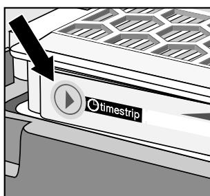
1. Ukoliko umesto filtera izlaznog vazduha **a** postavite filter **b**, **c**, **d** ili **e**, onda morate još da izvadite rešetku filtera i da potom ubacite odgovarajući novi filter izlaznog vazduha.
