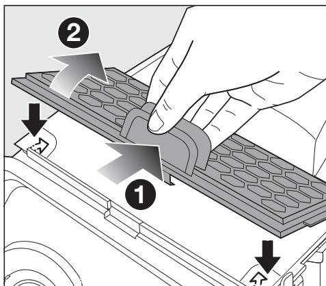
■ Pritisnite deo za oslobođanje rešetke filtera i otvorite rešetku filtera dok ne čujete zvuk uglavljivanja.
