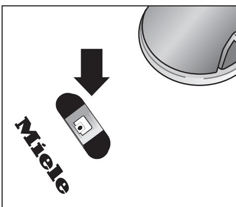
Zamenite kesu za usisivač kada se skala na kontrolnom prozorčiću indikatora potrebe zamene kese za usisivač ispunji crvenom bojom.
