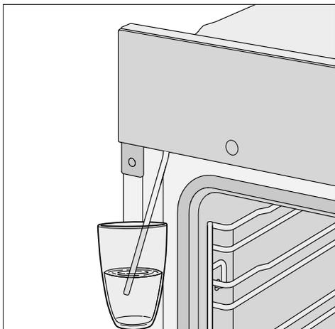
■ Tauchen Sie das Einfüllrohr in das Gefäß mit Leitungswasser.
