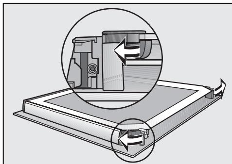
■ Okretanjem otvorite obje blokade za ploče vrata prema van.
