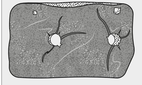
Lo blåses ufiltrert inn i varmeveksleren gjennom rifter og sprekker og forårsaker tilstoppinger.
