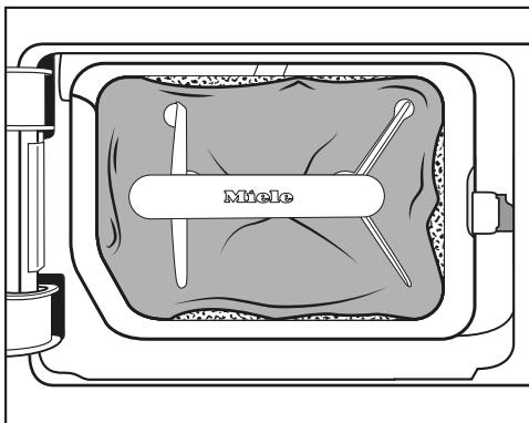
Filteret ligger ikke inntil kantene og filteret er deformert. På de stedene filteret ikke ligger helt inntil kanten, vil lo blåses ufiltrert inn i varmeveksleren. På denne måten blir varmeveksleren etterhvert tilstoppet.
