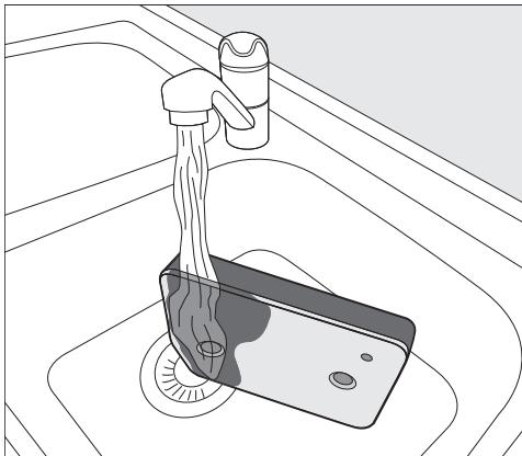
**Tips:** For at eventuelle rester på overflaten skal fjernes raskere lar du vannet renne loddrett over fronten av sokkelfilteret.
