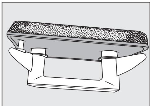
Restene kommer fra tekstilfibere og vaskemidler som tetter filteret. Du finner dem på forsiden og på kantene av filteret. I ekstreme tilfeller danner disse restene harde avleiringer.
