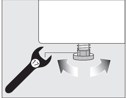
Compensare le irregolarità del pavimento svitando i piedini.
