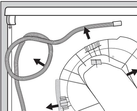
■ Rimuovere il tubo di scarico dai ganci di fissaggio.
