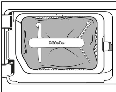
I bordi del filtro non aderiscono e il filtro è deformato. Per questo motivo la lanugine passa dai bordi che non aderiscono e raggiunge lo scambiatore di calore. A lungo andare lo scambiatore di calore si blocca.
