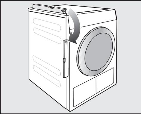
Per funzionare in modo ottimale, l'essiccatoio deve essere posizionato in bolla.
