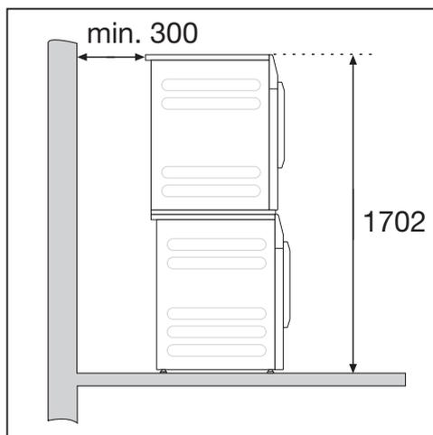
È necessario un kit di giunzione\*. Il kit di giunzione deve essere montato da personale tecnico autorizzato Miele.
