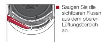
Saugen Sie die sichtbaren Flusen aus dem oberen Lüftungsbereich ab.
