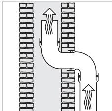
Ako se odvod zraka provodi kroz dimnjak, odvodni nastavak se mora usmjeriti u smjeru strujanja zraka.
