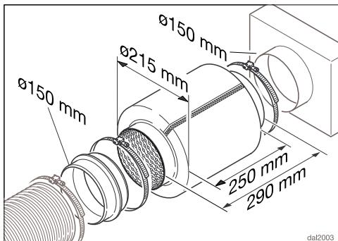
Za dodatno prigušivanje buke, u cijevi za odvod zraka može se postaviti prigušivač buke (dodatni pribor).
