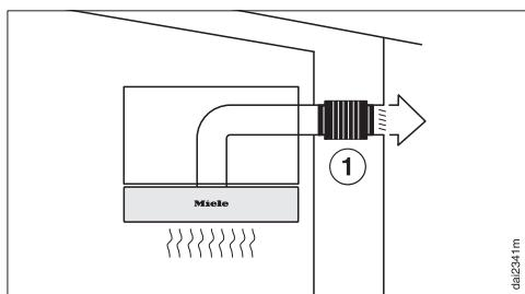
Kod načina rada na odvod zraka, prigušivač buke prigušuje kako zvukove ventilatora prema van tako i vanjske zvukove, koji putem cijevi za odvod zraka prodiru u kuhinju (npr. ulična buka). Stoga se prigušivač buke postavlja što je moguće bliže ispred izlaza zraka (1).
