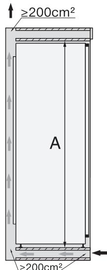
\* Deklarovaná spotreba energie bola meraná s hĺbkou výklenku 560 mm. Pri hĺbke výklenku 550 mm je prístroj plne funkčný, má ale zanedbateľne vyššiu spotrebu energie.
