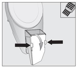
■ 按壓濾網框側面的兩個鎖扣,取出濾網。
