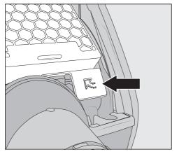
■ 將排氣濾網可取出卡扣向上拉,並將 排氣濾網向前拉,將其取出。
