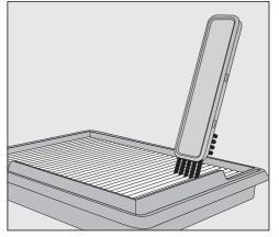
■ 用清潔工具上的長毛刷清潔微塵濾網 的褶皺面。
