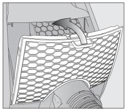
■ 將排氣濾網塵格蓋小心地裝入排氣濾網塵格的底部,並關閉蓋子,確保其 卡入位置。
