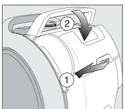
■ 手柄向上抬起,將乾集塵箱以一定角 度插入吸塵機。 ■ 將手柄向後推,將集塵箱鎖定到位。
