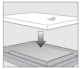
■ 將乾濾墊連接到乾微塵濾網上,使濾 墊的柔軟表面朝上,並能看到用於去 除濾墊的圈絨。
