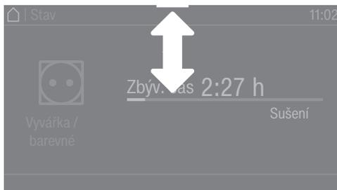
Když se u horního okraje obrazovky uprostřed displeje objeví oranžový proužek, můžete si nechat zobrazit stahovací menu. Dotkněte se proužku a přejeďte prstem po displeji dolů. Chcete-li stahovací menu opět zavřít, stiskněte oranžový proužek a přejeďte prstem na displeji směrem nahoru.
