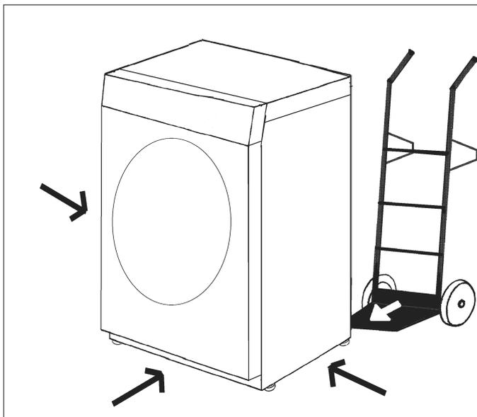
Sušičku prepravte na miesto inštalácie pomocou vhodnej prepravnej pomôcky (napr. ručného vozíka).
