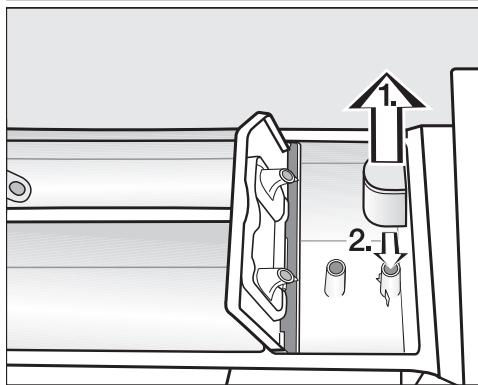
1. Usisnu cjevčicu izvucite iz pretinca
