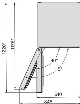
\* Dimenzija bez postavljenog dodatka za odmak od zida. Ako se koriste priloženi dodaci za odmak od zida, dubina za ugradnju uređaja povećava se za 15 mm.
