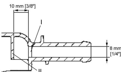
Il faut faire attention à ne percer que la première cloison (**I**) car une cloison d'impact (**II**) se trouve environ 10 mm derrière.
