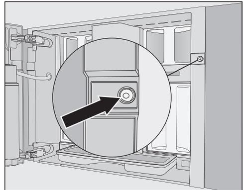
No orifício do parafuso existe uma saliência de silicone de cor vermelha que fixa a porta do aparelho durante o transporte, evitando assim danos de transporte no aparelho.
