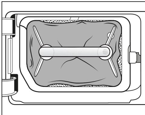
스펀지 필터가 적절히 장착되어 있지 않으며 스펀지 필터가 변형되었습니다. 스펀지 필터가 제대로 장착되지 않으면 가장자리의 틈 사이로 보풀이 통과해서 열교환기에 들어가게 됩니다. 이로 인해 열교환기가 막히게 됩니다.
