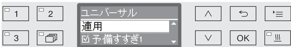
割り当てには複数の選択肢があります。ディスプレイのすべての洗浄ブロックの横にボックスが表示されます。洗浄ブロックがプログラムに割り当てられると、ボックスにチェックマーク☑が付きます。ボックスにチェックマークを入れると、この洗浄ブロックがプログラムに割り当てられ、チェックマークを外せば、割り当てを削除できます。
