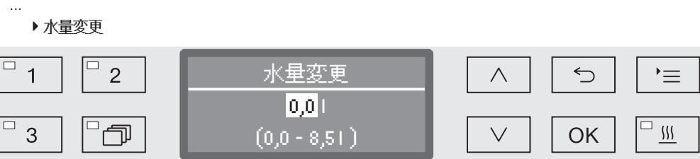
水量は0.5 l単位で増やすか、または工場出荷時設定の量に戻すことができます。可能な範囲が最下行に表示されます。設定「0 l」は、工場出荷時設定と同じです。
