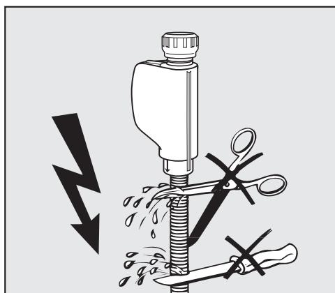
**⚠️ 機器付属の給水ホースを短くしたり、損傷させたり しないでください。**
