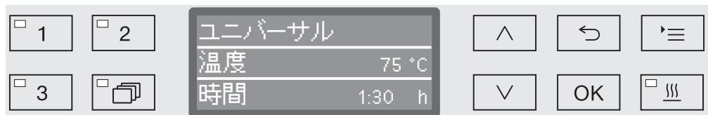
選択したボタンのLEDが点灯し、ディスプレイに関連するプログラムが表示されます。Start/Stop (開始/停止) ボタンのLEDも点滅し始めます。
