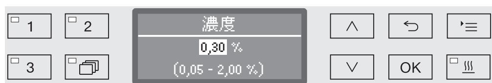
投入される洗剤の濃度は、0.01 刻みで調整できます。可能な範囲がディスプレイの最下行に表示されます。
