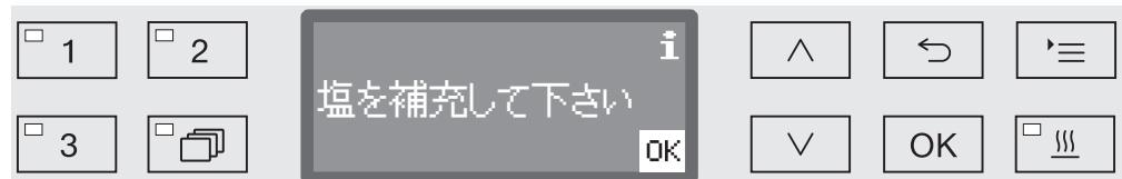
システムメッセージはプログラムの開始時と終了時に表示され、OKを使用して個別に確定（確認）するか、プログラムの終了時にドアを開けてまとめて確定（確認）する必要があります。ディスプレイに■の記号が表示されている場合、OKボタンを押すとシステムメッセージを開くことができます。
