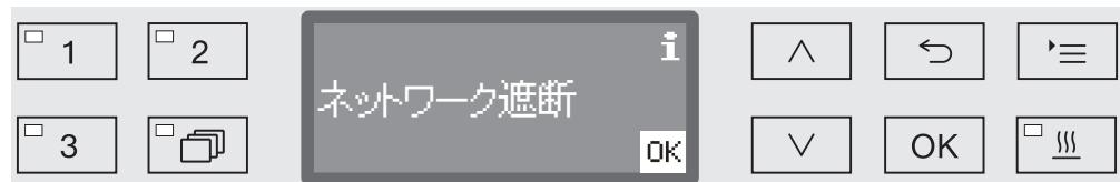
実行中の工程は中断することなく継続され、工程データはその間に内部メモリに保存されます。
