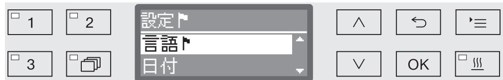
操作パネルの△と▽矢印ボタンを使用して、メニューをナビゲートします。
