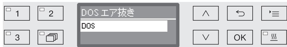
供給システムが選択されると、自動エア抜きが開始されます。開始すると、自動エア抜き工程はキャンセルできなくなります。
