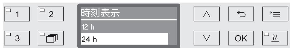
■ ▲および▼矢印ボタンを用いて希望の時計形式を選択し、OKを押して保存します。
