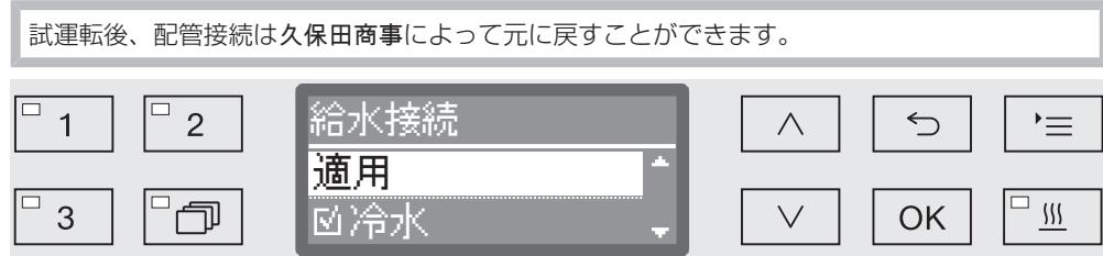
配管接続は、複数の選択肢を介して設定されます。ボックス  がすべての配管接続の横に表示されます。接続が有効になっている場合、ボックスにチェックマーク  が表示されます。有効化/無効化する配管接続を選択します。
