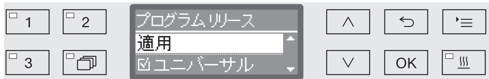
プログラムは複数の選択肢から選択されます。リスト内のすべてのプログラムの横にボックスが表示されます。プログラムがリリースされると、ボックスにチェックマークが付きます。空のボックスは、ブロックされたプログラムを示します。
