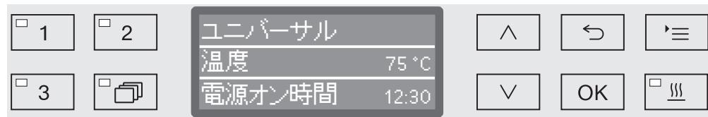
選択したプログラムが設定した開始時間でディスプレイに表示されます。自動無効化が選択されている場合（「拡張設定/電源オフまでの時間後でオフにする」を参照）、設定時間後にプログラムの開始時間に達するまで機器は自動的にオフになります。
