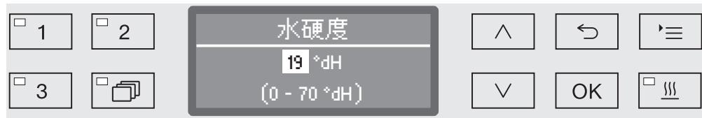
可能な範囲がディスプレイの最下行に表示されます。水の硬度の設定値は、「軟水化装置/設定」のチャートに記載されています。
