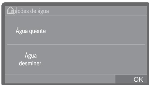
Tocando podem selecionar-se e desmarcar-se ligações à água. As ligações à água ativadas estão realçadas a cores.
