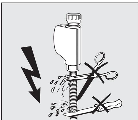
⚠ Perigo de choque elétrico devido à tensão de rede.
