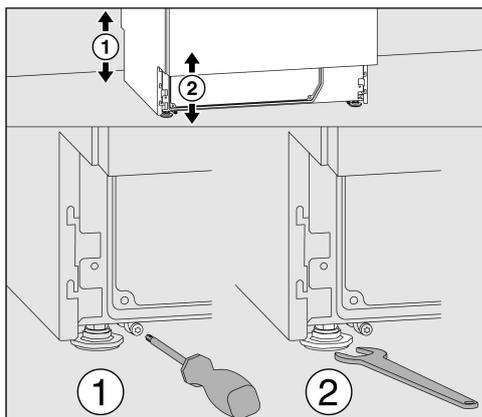
Os pés aparafusáveis dianteiros podem ser ajustados com uma chave de bocas (tamanho 13), os pés traseiros com um parafuso Torx T20. Se não se montarem os patins dos pés aparafusáveis traseiros, estes também podem ser ajustados com a chave de bocas.
