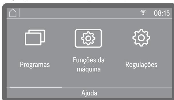
No caso de máquinas de lavar e desinfetar ligadas em rede, na parte superior do visor aparece o ícone da interface disponível. 📶 representa uma ligação Wi-Fi; L uma ligação LAN por cabo. Se a máquina de lavar e desinfetar não conseguir estabelecer uma ligação Wi-Fi ao router, o símbolo é exibido com um risco em conformidade 🚫.
