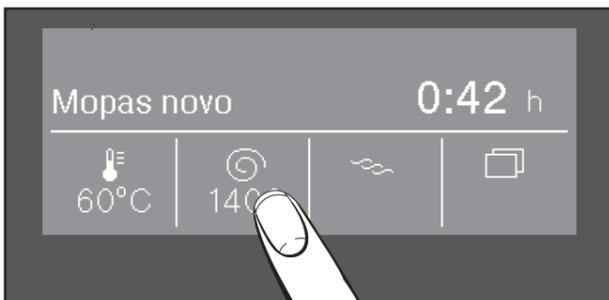
Com as teclas sensoras , ou pode alterar temperatura, velocidade de rotação ou extras.
